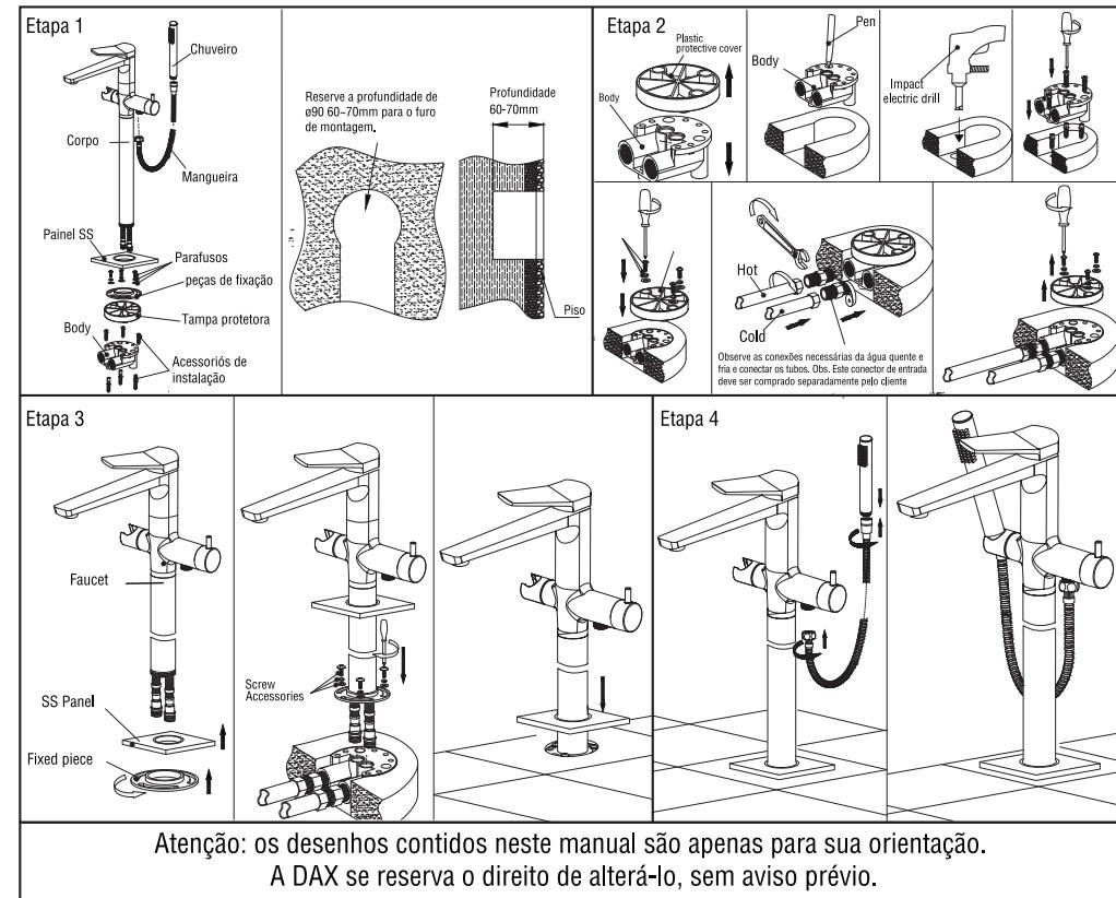
Etapa 1. Com uma furadeira elétrica, faça um furo no chão com profundidade entre 60-70mm para montagem da base.
