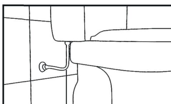
Passe a canopla, rosqueie fita veda rosca na extremidade do engate flexível, e rosqueie a extremidade no ponto de água. Aperte com a ferramenta adequada. Rosqueie a fita veda rosca na caixa acoplada e rosqueie o engate flexível na mesma.
