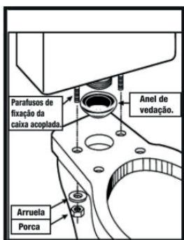
Coloque o anel de vedação na saída da caixa acoplada e em seguida coloque a caixa acoplada na bacia de maneira que o anel preencha a entrada da bacia e que os parafusos de montagem da caixa passem através dos buracos de montagem. Agora coloque as arruelas nos parafusos de montagem e em seguida as porcas. Aperte alternadamente até a caixa acoplada estar completamente sobre a bacia e paralelo a parede.
