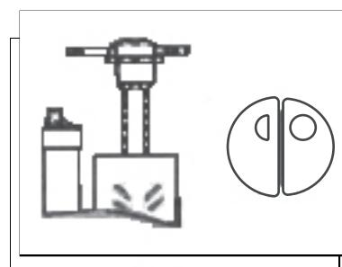
3. Colocar os parafusos corretamente na descarga do mecanismo
