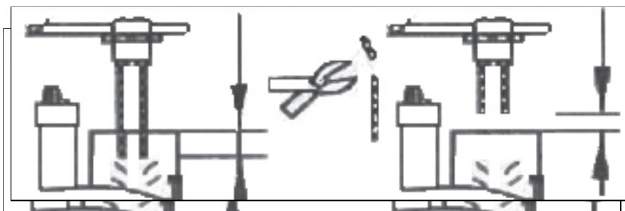
4. Colocar os parafusos na medida correta para não danificar as molas do mecanismo.
