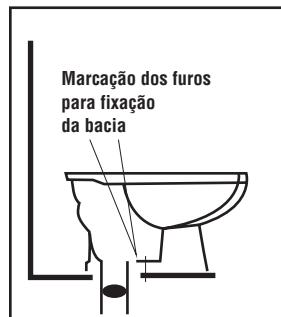
3. Faça a marcação dos furos no piso, para fixação de bacia no piso.
