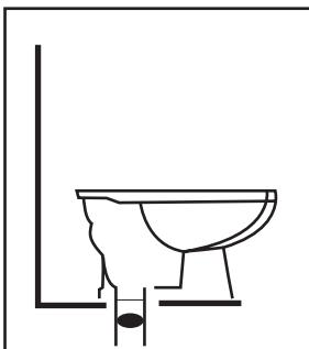
2. Alinhe o cano de saída de esgoto da bacia com o cano de esgoto do local de instalação, e encaixe a bacia com cuidado.
